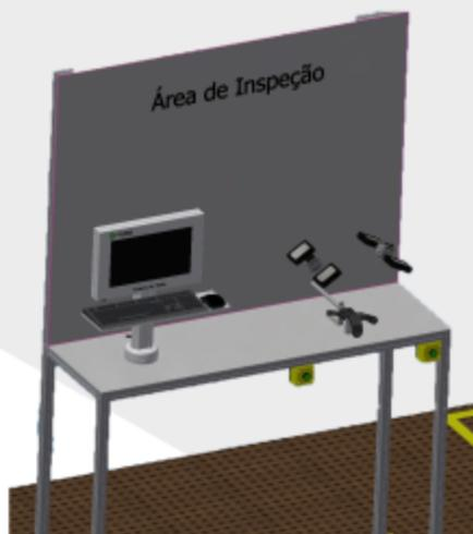
Estação de inspeção automática por sistema de visão
