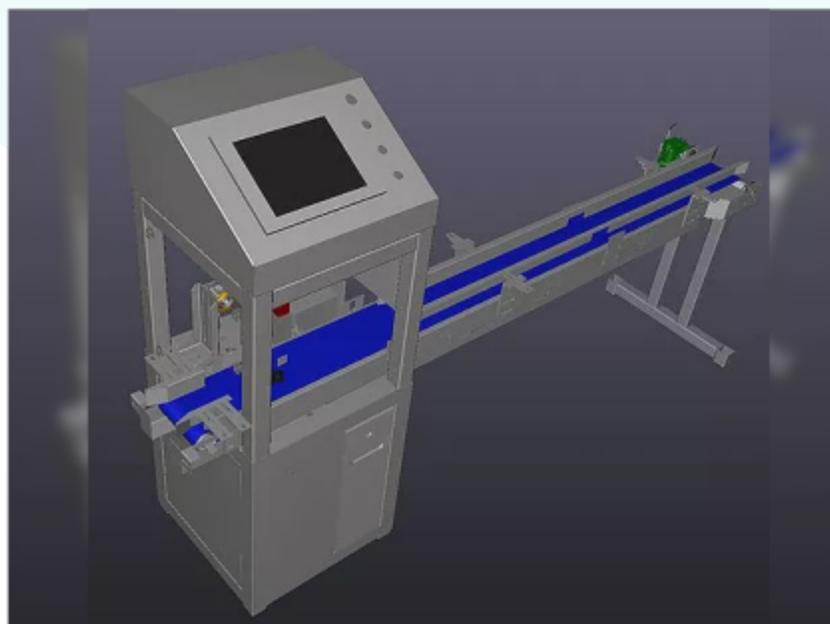
Projeto feito sob as **necessidades** da linha do **cliente**. Todo desenvolvido em plataforma **CAD 3D** (Inventor). Conforme especificações da linha.
