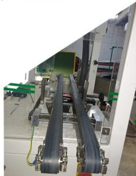
Por debaixo vão duas **câmeras** Cognex e **iluminação** especial a leds que fazem a inspeção dos furos e roscas.
