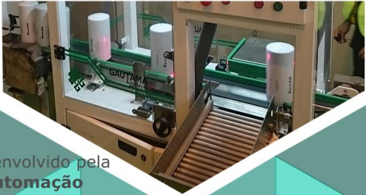
Sistema desenvolvido pela **Gautama Automação** para inspeção de diâmetro de furo e passos de rosca em filtro de óleo automotivos.
