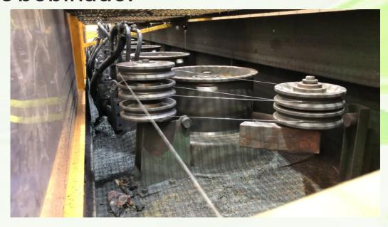
Nesse sistema utilizado para as amarrações da bobina, foi instalado câmera com proteção, iluminação e um programa, para realizar a inspeção.
