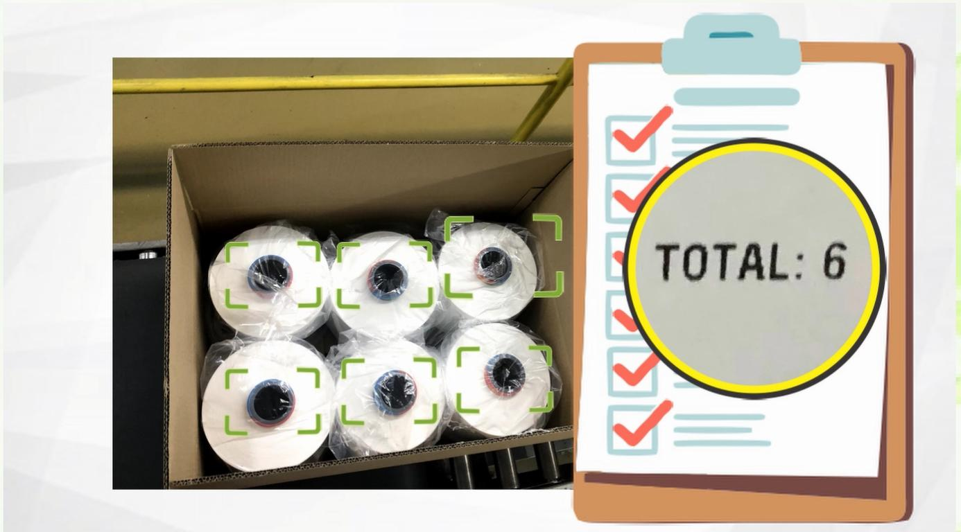
Através de uma câmera de alta resolução colocada em cima de onde as caixas passam, o sistema por meio do processamento de imagens identifica as bobinas e conta o total.
