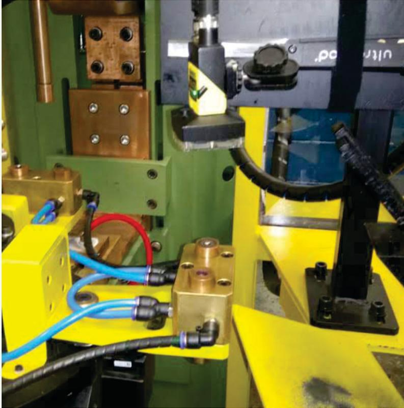
Aplicação com uma câmera inteligente que identifica se existe uma porca soldada em suporte metálico. Através dessa câmera o sistema recebe as imagens e inspeciona o a presença e o correto posicionamento das porcas se estão viradas para cima ou para baixo.
